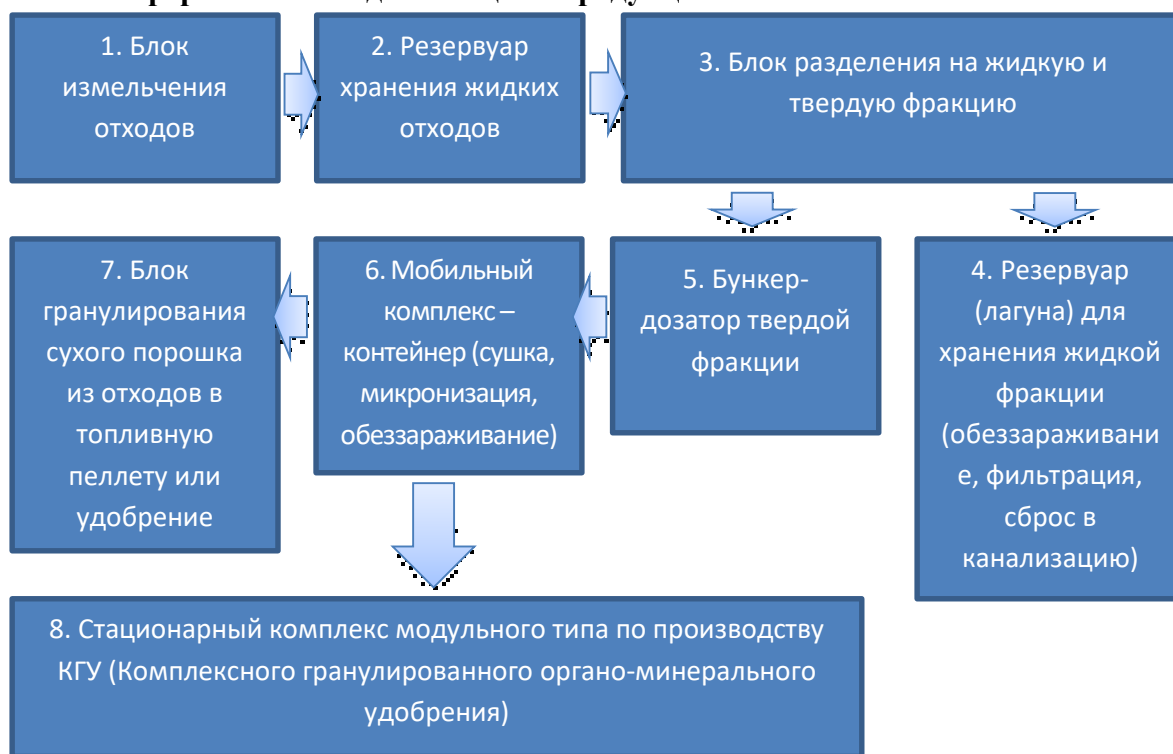
Схема переработки отходов овощной продукции влажностью 85-90%.
